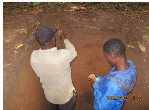
Figura 10: Colecta de amostras de anéis para Densidade aparente
