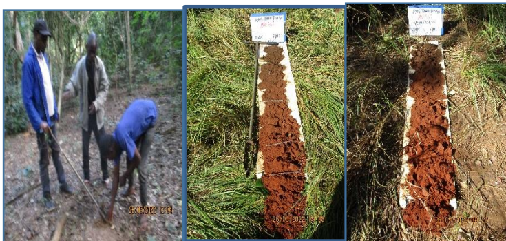
Ilustração 1: sondagens para identificação de características homogêneas
