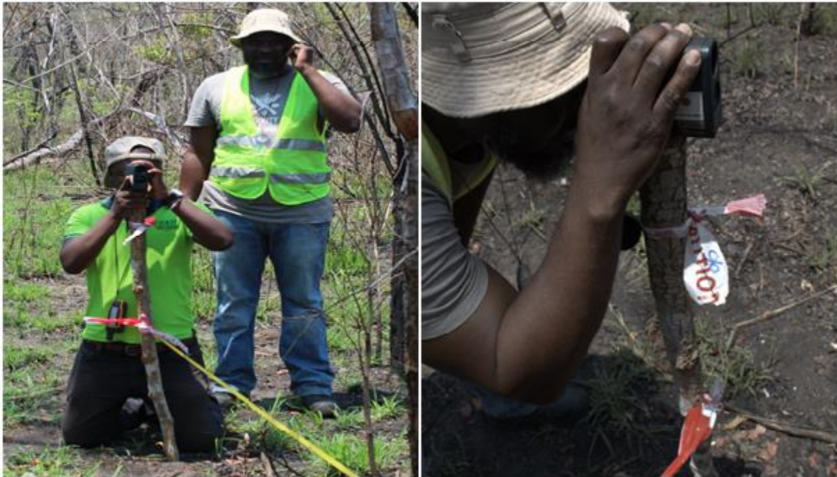
Figura 3: Demarcação da parcela usando o TruPulse.
