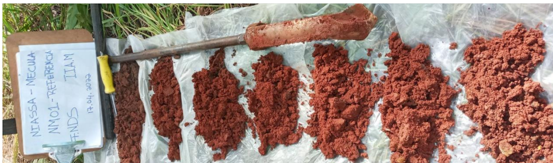
Figura 9: Ilustração das amostras de solo resultantes da sondagem de referência no centro da PAP-NM01.
